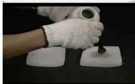
図2 ドライアイス中にマグネシウム粉末を入れる
